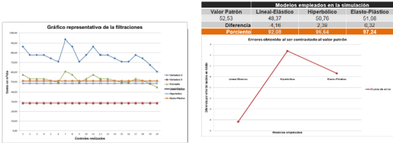
Figura 4. Análisis del comportamiento de la patología de filtraciones en la sección típica del Embalse Palmarito.
