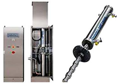
Figura 3. UIP 16000, el procesador ultrasónico más poderoso del mundo: 16000 watts de potencia para procesamiento de volúmenes grandes en procesos para homogeneizar, dispersar o desaglomerar. Diseñado para trabajar en clusters de tres o más unidades.
