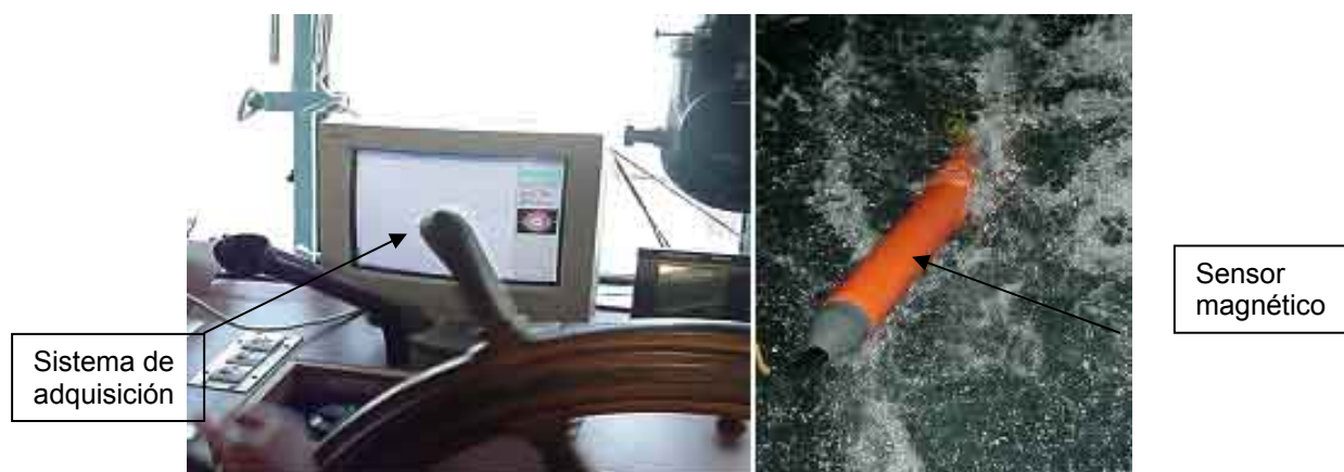
Figura 1 Sistema de adquisición y sensor del Magnetómetro Protónico SeaSPY.
