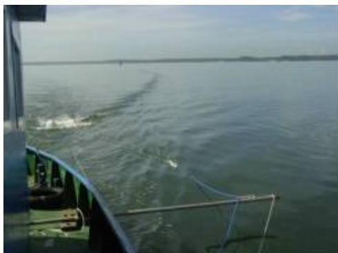
Sistema de remolque de la fuente boomer y el hidrofono mediante mástil lateral en la banda de la embarcación
