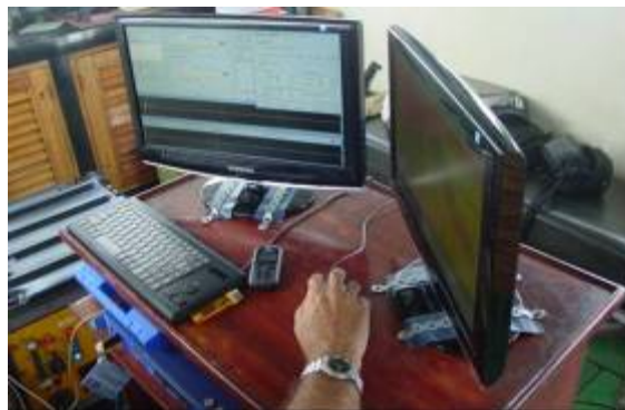
Sistema de adquisición y procesamiento CODA DA 2000 instalado en la cabina de la embarcación utilizada, con una pantalla para el control de los parámetros técnicos y otra para la visualización de los datos que se van adquiriendo.
