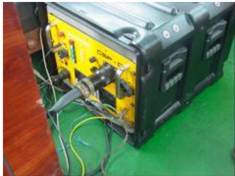
Unidad de almacenamiento y transmisión de energía para los pulsos acústicos CSP-D y Boomer AA 300
