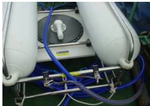
Unidad de almacenamiento y transmisión de energía para los pulsos acústicos CSP-D y Boomer AA 300
